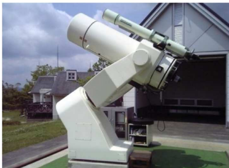
本所が有する山口県下最大の天体望遠鏡 （反射式 510mm）
