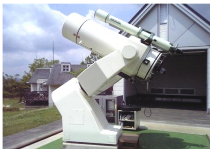
県下最大の反射式望遠鏡（口径510ミリ）
