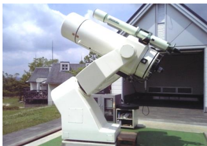
県下最大の反射式望遠鏡（口径510ミリ）
