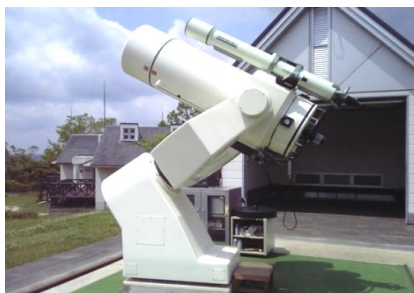
県下最大の反射式望遠鏡（口径510ミリ）
