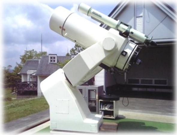
県下最大の反射式望遠鏡 (口径 510 ミリ)
